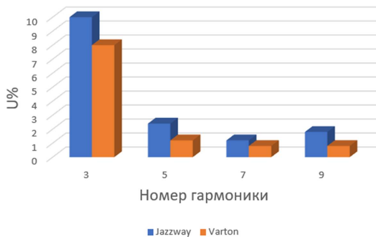
Рисунок 1 – Гистограммы гармонической составляющей напряжения в процентах
