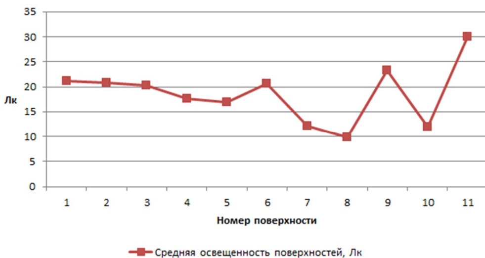
Рисунок 2 – Средняя освещенность рассчитываемых поверхностей после 3 лет эксплуатации
