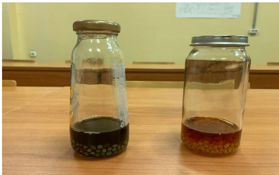
Рисунок 3 – Пробы масла с силикагелем
