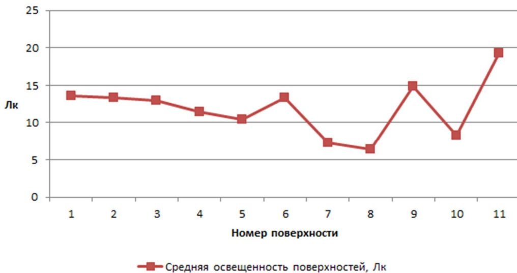
Рисунок 2 – Средняя освещенность рассчитываемых поверхностей после 3 лет эксплуатации и снижении срока службы в два раза
